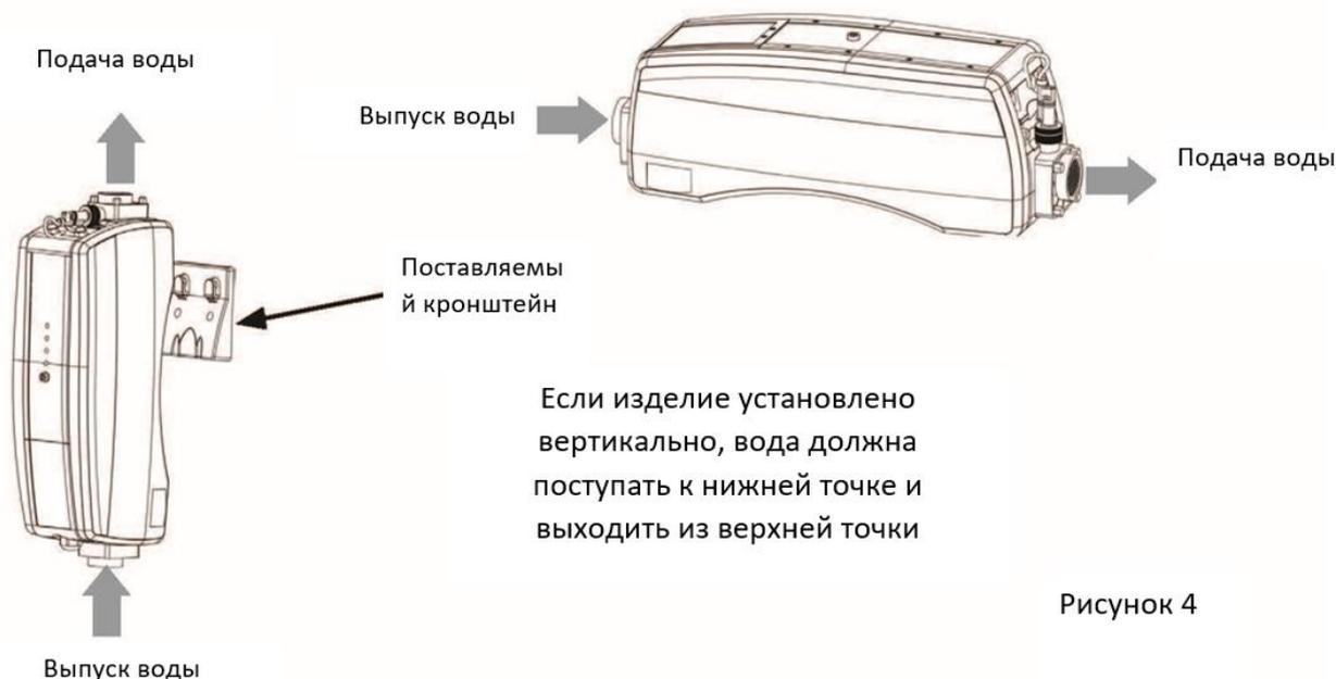
Важно, чтобы трубопроводы, присоединенные к входу и выходу нагревателя, имели внутренний диаметр не менее 32 мм. Для обеспечения нормального удаления воздуха и для того, чтобы во время работы нагреватель всегда был заполнен водой, в возвратном трубопроводе, по которому вода подается обратно в бассейн, должен быть предусмотрен защитный элемент или подъем как можно ближе к нагревателю (см. рисунок 2).
