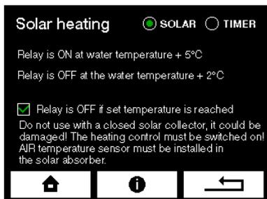
Um diese Funktion zu nutzen, wählen Sie im Menü "PROGRAMMIERBARES RELAIS" die Option "SOLAR". Installieren Sie den Lufttemperatursensor im Kreislauf der Solarabsorber. An das potentialfreie Relais "TIMER/HEIZUNG" schließen das Zubehör an, was Sie damit steuern möchten.
