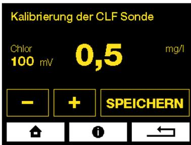
Kalibrieren Sie die Sonde erst nach dem **Durchmischen** des Schwimmbeckens und der **Stabilisierung** des Chlor- und pH Werts auf dem Display der DOS-COMLETE.
