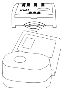
Encoche pour IR transmission de données
