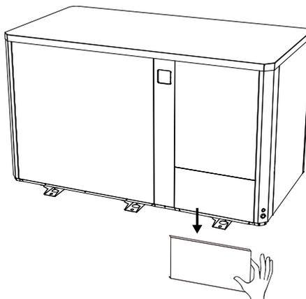
③ Entfernen Sie zwei Schrauben im Inneren
