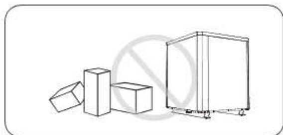
1.4.4. Legen Sie keine Gegenstände in den Ein- oder Auslass, da andernfalls die Effizienz der Wärmepumpe reduziert oder diese sogar gestoppt werden kann.
