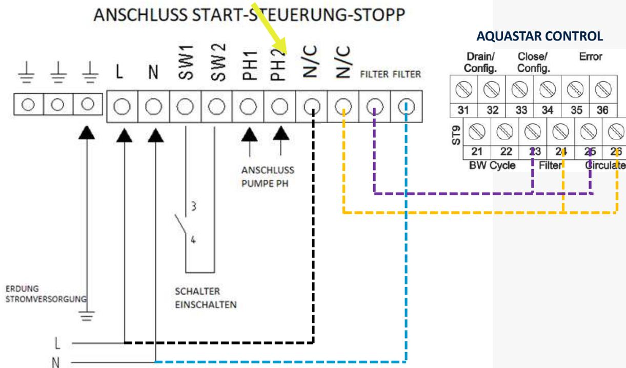
**VARIANTE 3.0: MIT START-STOPP FUNKTION + AQUASTAR CONTROL + PUMPE** bei der keine 230V abgegriffen werden können, oder wenn keine Verbindung besteht
