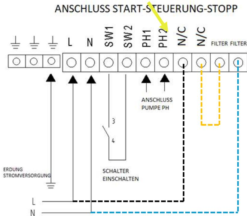
**VARIANTE 2.2: MIT START-STOPP FUNKTION + PUMPE bei der keine 230V abgegriffen werden können, oder wenn keine Verbindung besteht**
